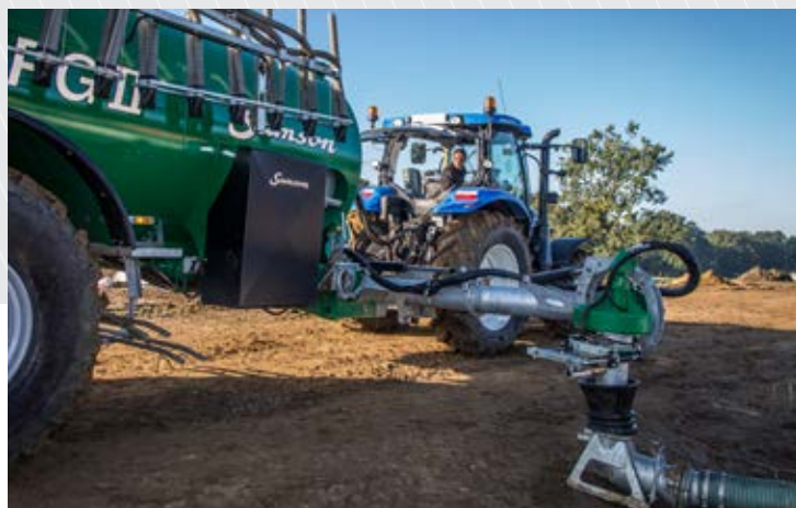
Fyldning via fyldetragt.
