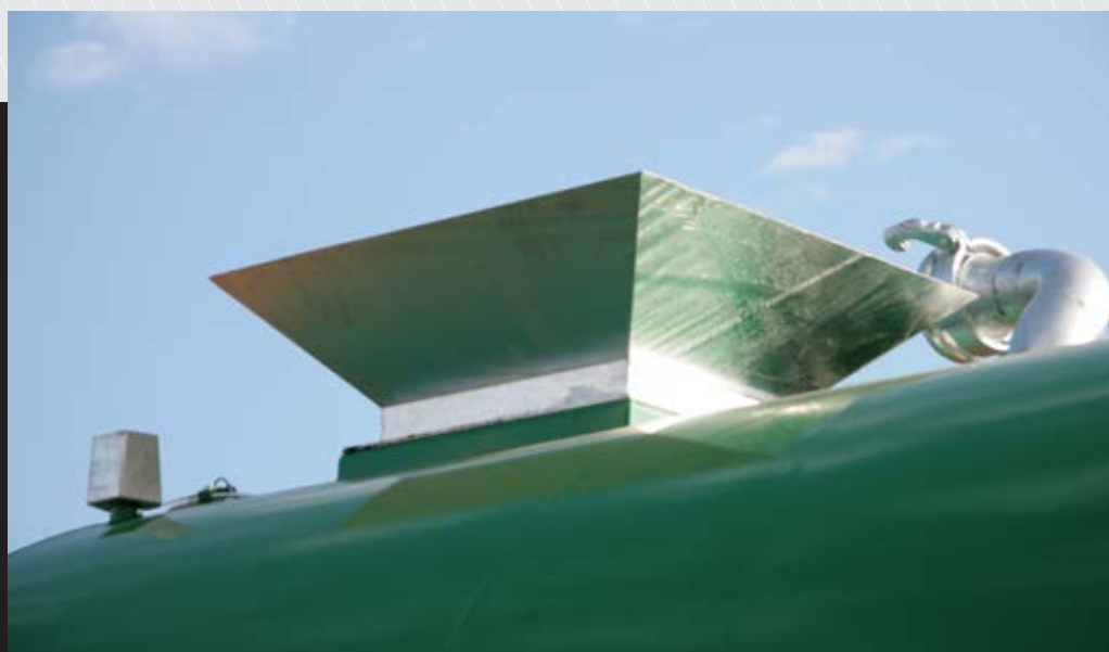
Ekstern fyldning via fyldetragt
