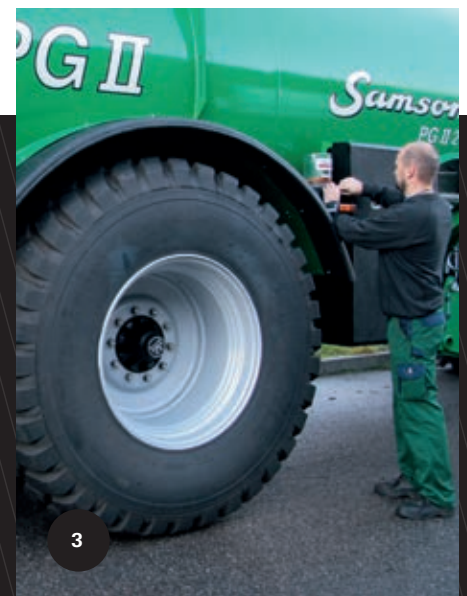
De mandshøje hjul giver mindre rullemodstand.
