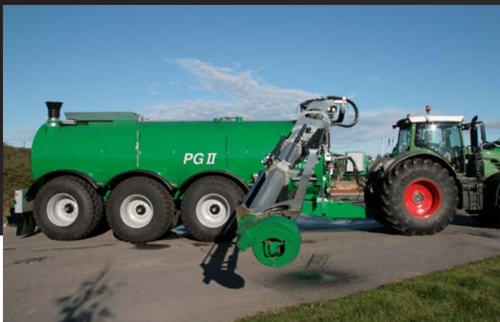
Pumpetårn med teleskoparm.
