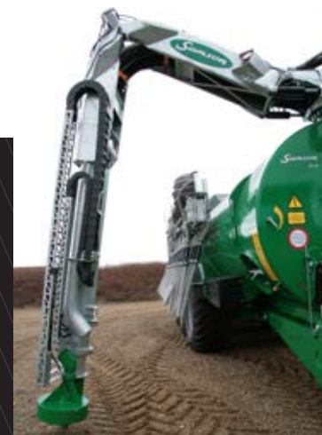
Pumpetårnet er mere fleksibelt, så det nemmere kan køres ned i åbningen på overdækninger til gylletanke eller ned i gyllelagre under stalde.
