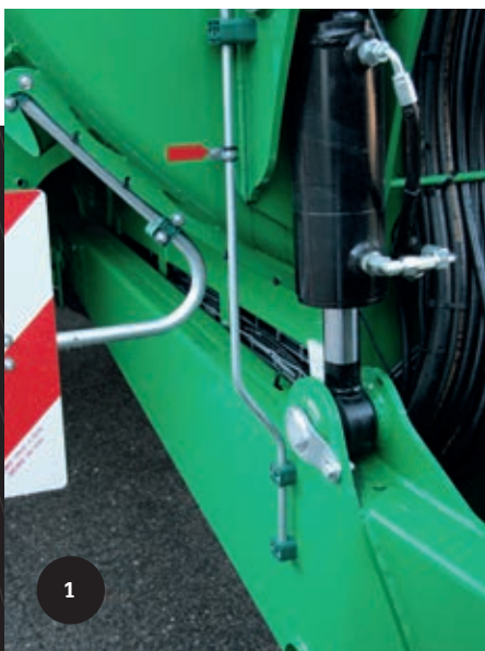
Den affjedrende træktriangel giver optimal kørekomfort. Den kan desuden justere trækhøjden.
