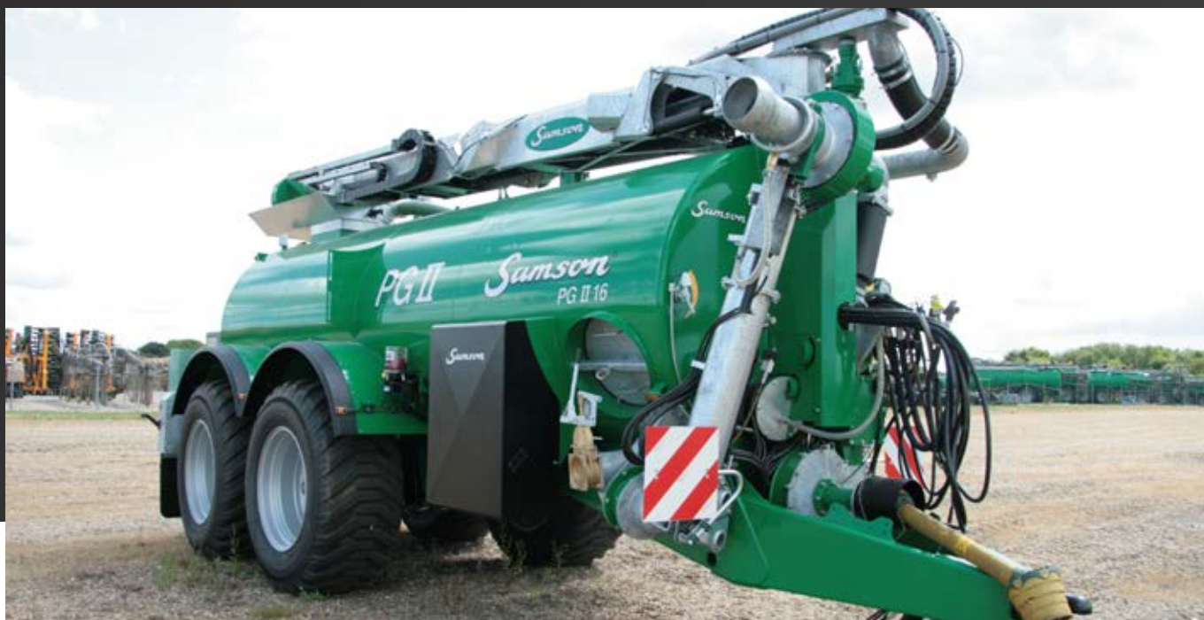
Et-leddet SAP-arm (SAP1) – med eller uden pumpe
