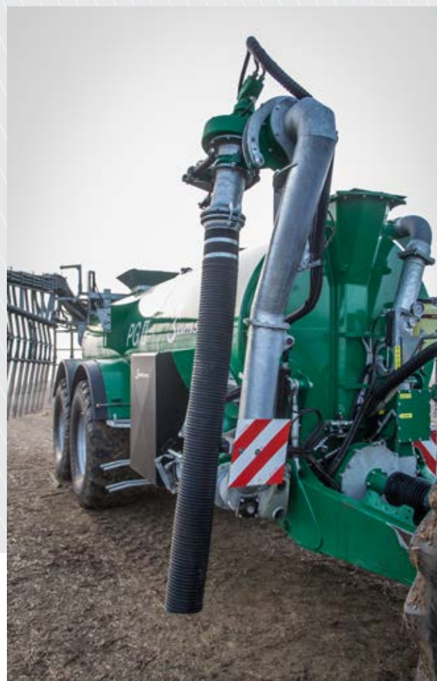
SAP2 med fyldeslange monteret
