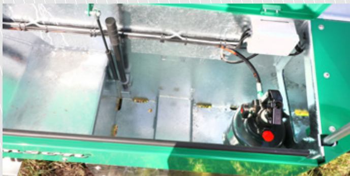
Håndpumpen sidder godt beskyttet i opbevaringsrummet.
